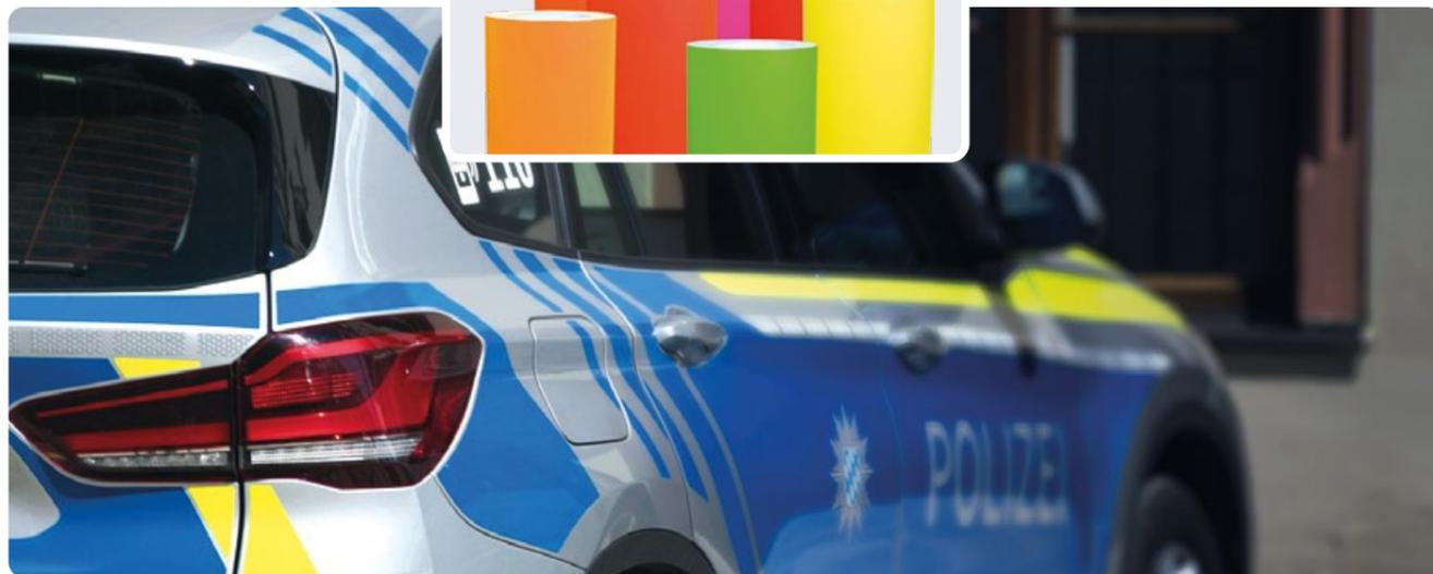
zählen die fluor-lime/rot oder die rot-weiß schraffierten Warnmarkierungen, Konturmarkierungen und reflektierende Schriftzüge. Für eine stärkere Signalwirkung auch am Tag werden Einsatzfahrzeuge zusätzlich mit fluoreszierenden Folien beklebt.
