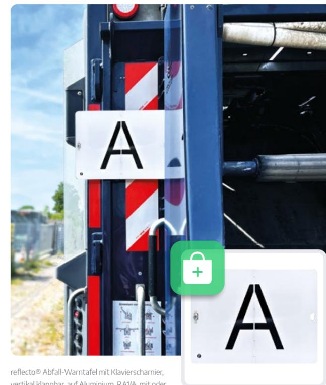
reflecto® Abfall-Warntafel mit Klavierscharnier, vertikal klappbar, auf Aluminium, RA1/A, mit oder ohne Kantenschutz
